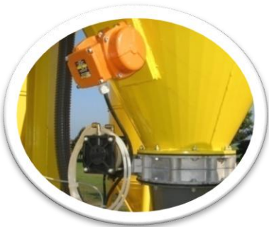
Waga cementu zawieszona na czujnikach tensometrycznych
