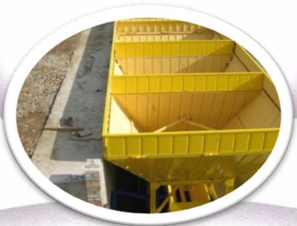
Zasobniki kruszywa wykonane z grubej, stalowej blachy
