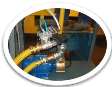
Objęściowy układ dozowania wody
