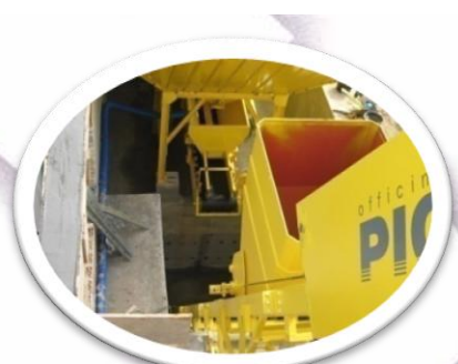
Kosz zasypowy posiadający dwie prędkości jazdy
