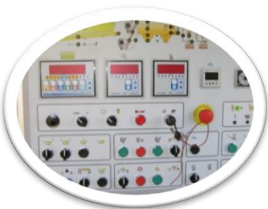
Tablica synoptyczna służąca do wizualizacji procesu technologicznego
