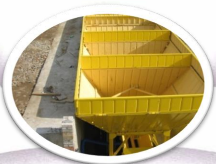
Zasobniki kruszywa wykonane z grubej, stalowej blachy
