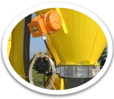
Waga cementu zawieszona na czujnikach tensometrycznych
