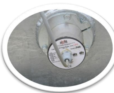
Mikrofalowa sonda do określania wilgotności kruszywa
