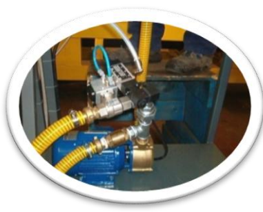
Objęściowy układ dozowania wody
